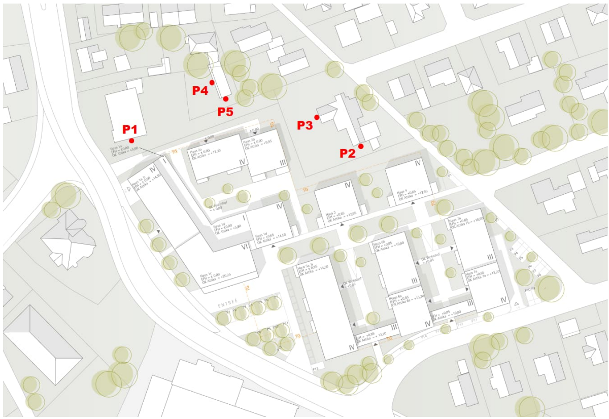
Abbildung 1: Punkte an den Fassaden der Nachbargebäude zur Bewertung der Verschattung
