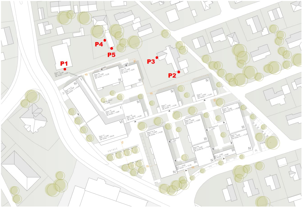
Abbildung 1: Punkte an den Fassaden der Nachbargebäude zur Bewertung der Verschattung
