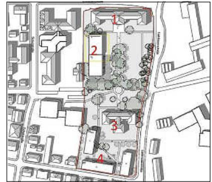
Zum ersten Bauabschnitt gehört die Ertüchtigung der beiden Bestandsgebäude (1, 3). Die Neubauten (2, 4) gehören zum zweiten Bauabschnitt. Darstellung: Vermögen und Bau, Amt Ravensburg
